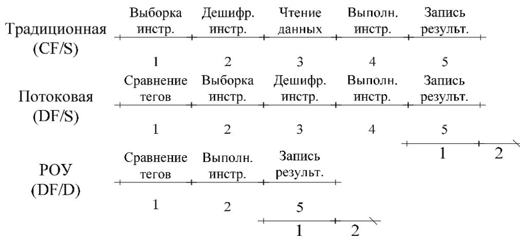
Рисунок 2. Выполнение инструкций в сравниваемых архитектурах.
