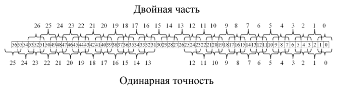
Fig. 3. Выделение троек разрядов в кодере Бута для двойной и одинарной точности
